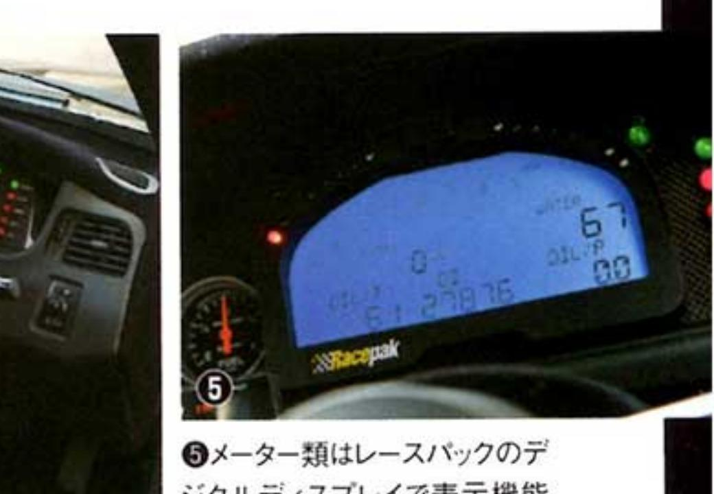
④ メーター類はレースパックのデジタルディスプレイで表示機能を集約。データロガー付きだ。
