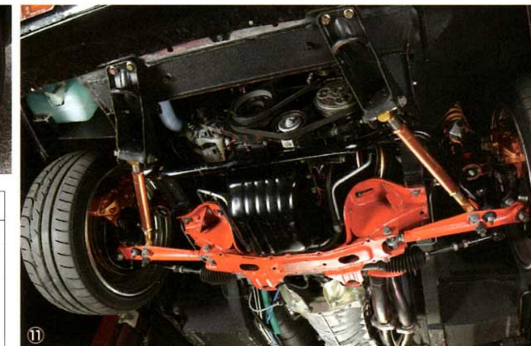
⑩ フロアごとR33スカイラインGT-Rのマルチリンクサスペンションが移植されたリアの足回り。デフもそのまま流用している。⑪フロントの足回りも、RB系エンジンを積む高年式の日産車から移植されたもの。
