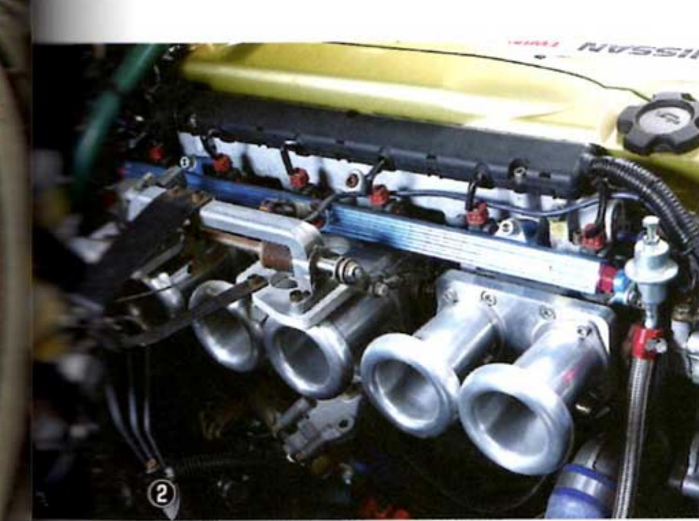
② ニスモが取り扱っていたRB30型ブロックを使い、そこにRB26型のヘッドを組み合わせたロッキーオートオリジナルのスポーツインジェクション仕様NAユニット。NAのツインカムユニットを積むというのは、ある意味昭和のGT-Rらしい選択といえる。組み合わされるエキマニは等長の6-2集合タイプ。元々はターボエンジンであるRB26型だけに、こうしたNA用等長エキマニとの組み合わせは見た目にも珍しい。エンジンの制御はF-CON Vproで行われ、このオリジナルエンジンで快調に作動させている。③ RB26型ヘッドの良さを生かして、スロットルは6連の独立仕様に、6つの吸気ファンネルが並ぶ様子は、ある意味旧車にも通じるビジュアルだ。この6連スロットルとエキマニのおかげで、エンジンのレスポンスは抜群に良い。L型とはまた違う感触だ。
